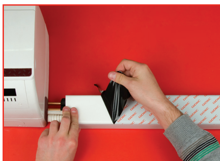
Снимите с крышки защитную пленку
